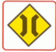
Narrow Bridge สะพานแคบ
