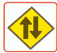
Two Way Traffic เดินรถสวนทางกัน
